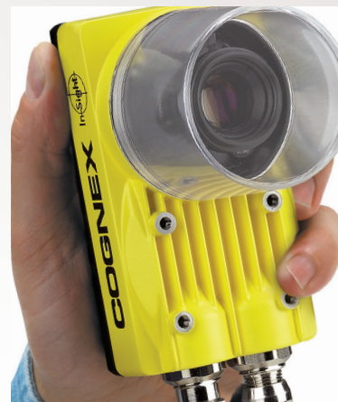
RobOptic er baseret på Cognex In-Sight, og kan konfigureres af teknikere uden særligt visionkendskab
