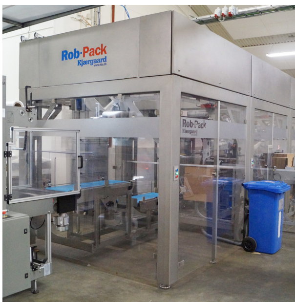
RobPack version 2, som laves i moduler af malet stål eller rustfrit stål. Bruges typisk til food og bryggeri branchen.
