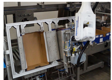
Robot fører emner ned i emballage i styrede bevægelser så sammenstød og stop undgås.
